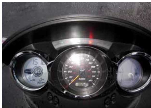
Schneller als gewünscht stehen Batterie und Restweiten-Anzeige bei zügiger Fahrt auf Null.
