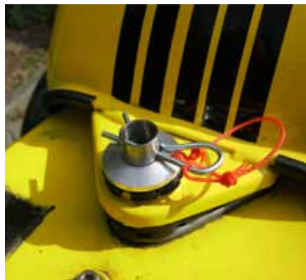
Schnellverschluss zum Tankwechseln. Auch ohne Training klappte der Wechsel gut.
